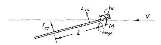
$$\overline{L}_{.25} = \pi \rho c V^{2} \overline{A}_{h} \overline{P}$$
