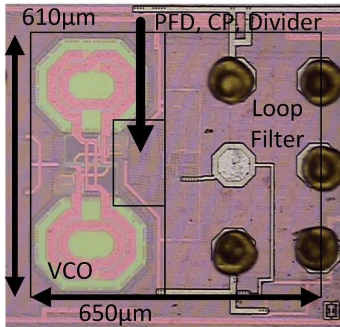
Figure 3.45: PLL die micrograph.
