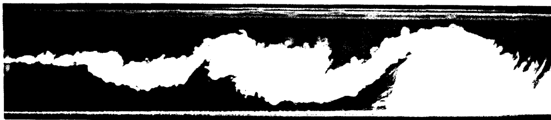
(d) F = 4 \text{ Hz} , F/F_0 = 0.06 , \lambda = 12 \text{ cm} \longleftrightarrow
