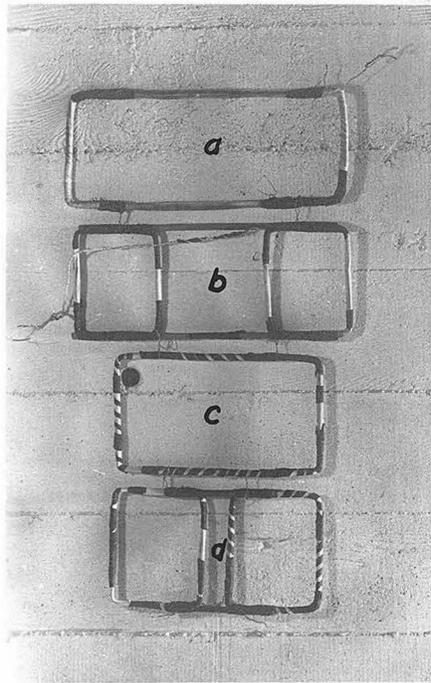
*Fig. 18. Rectangular Test Coils.*
